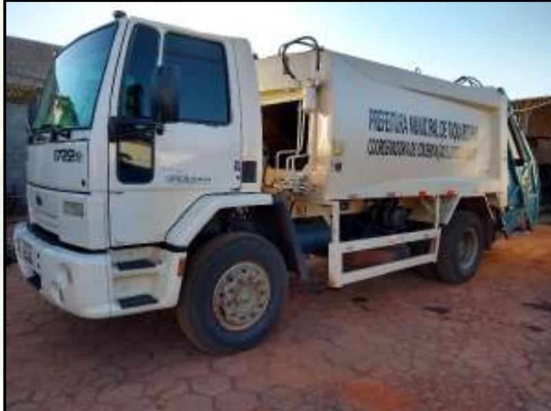
**Figura 25 – Caminhão compactador de 15 m<sup>3</sup> utilizado pela coleta regular**
